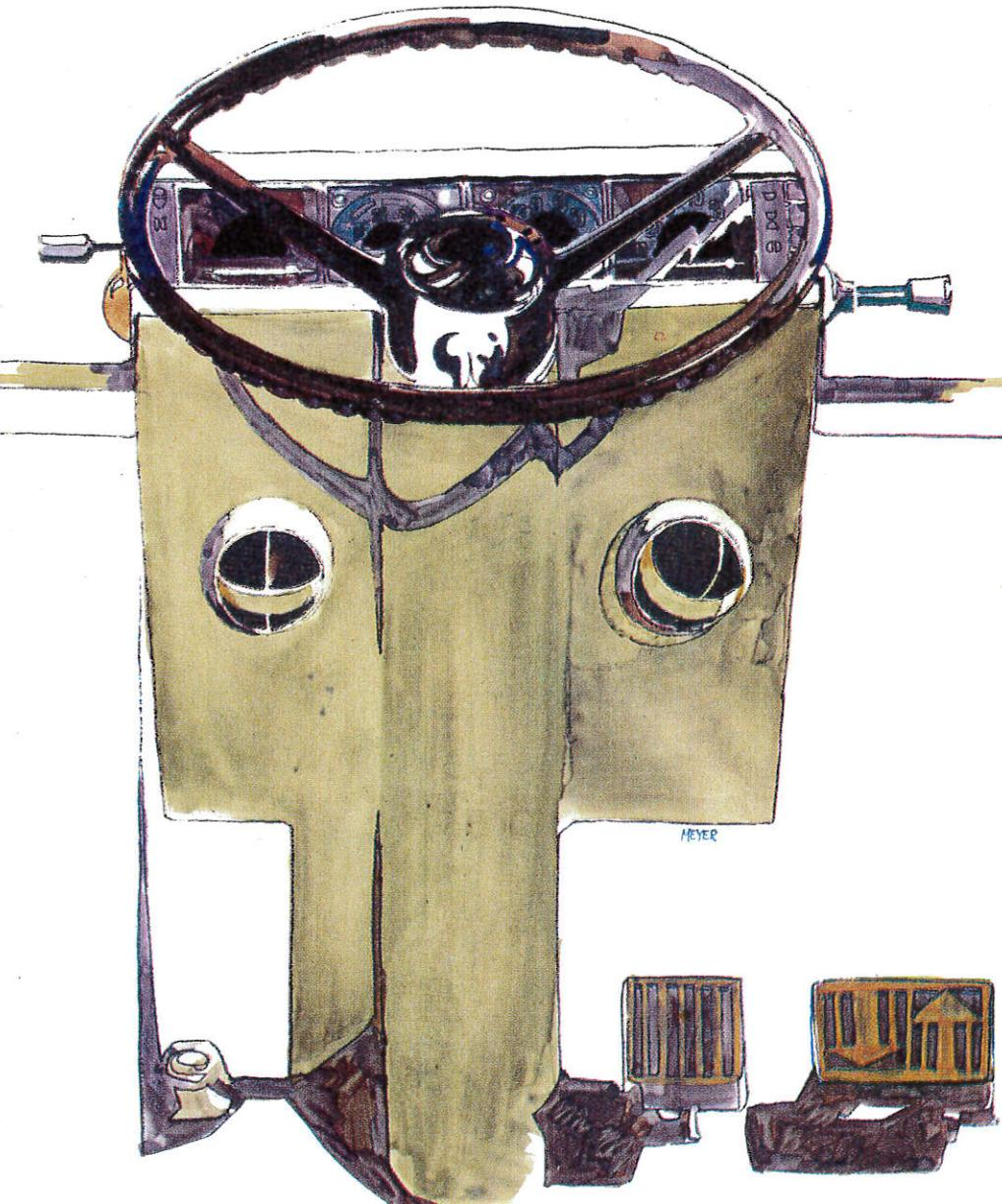
Føreren sitter høyt og har god oversikt. Setet er hydraulisk avfjernet. Foran seg har han instrumentbord med alle vanlige instrumenter, varsellys og hovedbryter med nøkkel, speedometer o.a. Til venstre for instrumentbordet spak for retningsviser, fjern- og nærlys. Til høyre en hendel for forover - null - bakover.
